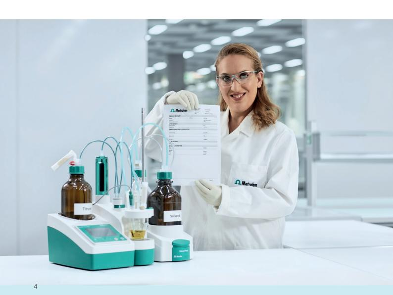
Der Eco KF Titrator mit integriertem Magnetrührer und Touch sensitivem Display ist ideal für die routinemässige Wasserbestimmung. Vordefinierte Methoden ermöglichen eine reibungslose und einfache Inbetriebnahme des Gerätes. Neben GLP konformen Ausdrucken auf Papier oder PDF bietet der Eco KF Titrator auch die Möglichkeit, Waagen anzubinden oder die Bestimmungsdaten als PC/LIMS Reports an einen PC zu senden.
