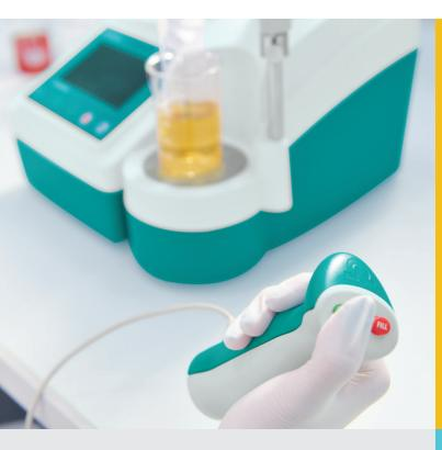
Der Eco Dosimat ist ein universell einsetzbarer Dispenser mit eingebautem Magnetrührer und Touch-Display.
