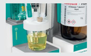
Statten Sie Ihren Eco-Karl-Fischer-Titrator einfach mit einem Homogenisator (Polytron) aus, um feste oder viskose Proben zuverlässig zu homogenisieren.
