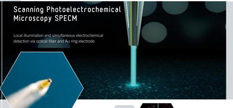
■ Core diameter: 200 µm
