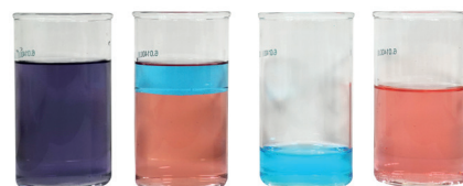
Représentation schématique de l'extraction (d.g.à.d.): mélange, mélange après le temps de séparation, phase organique recueillie, phase aqueuse restante
