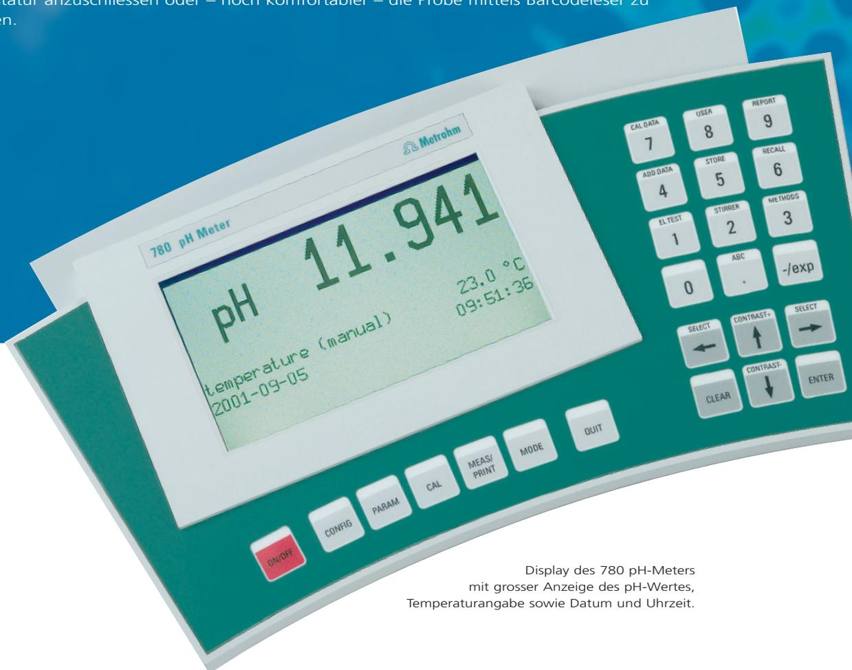
Display des 780 pH-Meters mit grosser Anzeige des pH-Wertes, Temperaturangabe sowie Datum und Uhrzeit.
