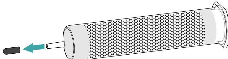
2. Coloque el filtro antipolvo en la punta del cartucho de adsorción de CO<sub>2</sub> CW.
