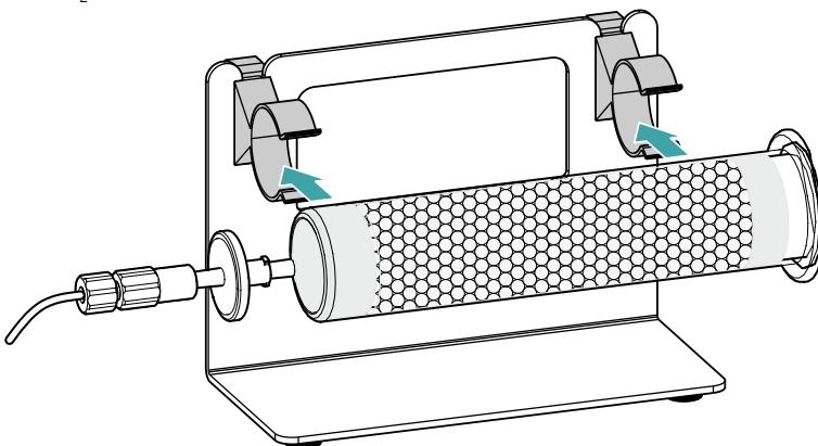
4. Den Adsorberkartuschen-Halter mit der CO<sub>2</sub>-Adsorberkartusche CW in den Detektorraum des Gerätes stellen.
