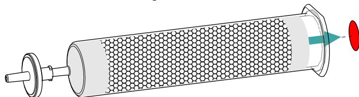
Damit öffnen Sie die kleine Öffnung im Deckel der CO<sub>2</sub>-Adsorberkartusche CW, durch welche die Luft ange-saugt wird.
