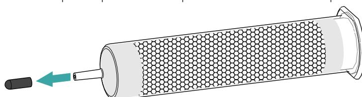
2. Enficher le filtre anti-poussière sur la pointe de la cartouche d'adsorption de CO<sub>2</sub> CW.
