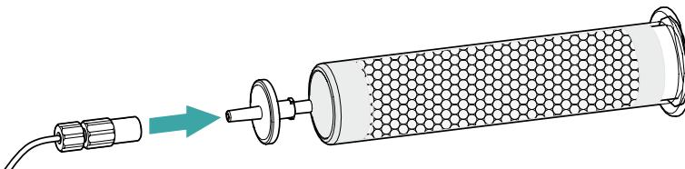
3. Fixer la cartouche d'adsorption de CO<sub>2</sub> CW avec les pinces sur le support de cartouches d'adsorption.
