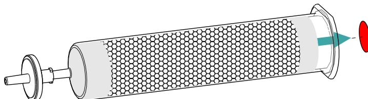
De esta forma, se abrirá el pequeño orificio de la tapa del cartucho de adsorción de CO<sub>2</sub> CW, a través del cual se aspira el aire.
