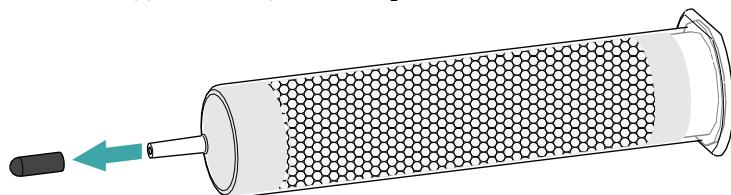
2. Den Staubfilter auf die Spitze der CO<sub>2</sub>-Adsorberkartusche CW aufstecken.
