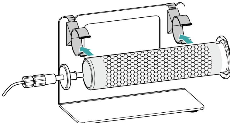
4. Coloque el soporte de los cartuchos de adsorción con el cartucho de adsorción de CO<sub>2</sub> CW en la cámara del detector del aparato.
