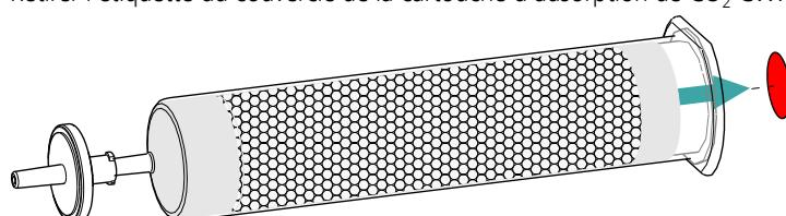
Vous ouvrez ainsi le petit orifice dans le couvercle de la cartouche d'adsorption de CO<sub>2</sub> CW à travers lequel l'air est aspiré.
