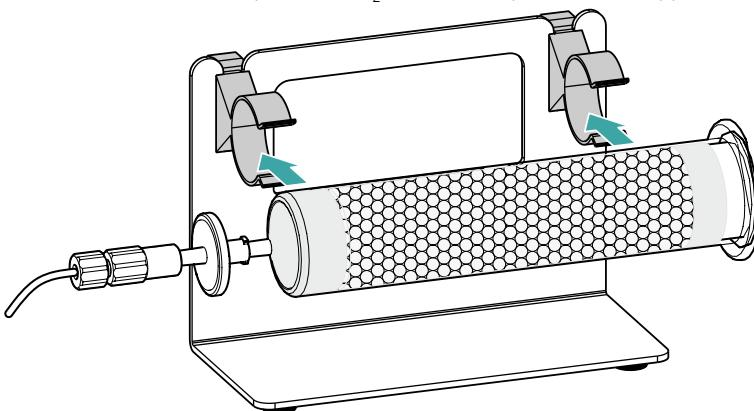
4. Placer le support de cartouches d'adsorption avec la cartouche d'adsorption de CO<sub>2</sub> CW dans la zone du détecteur de l'appareil.
