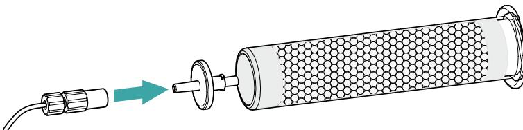
3. Die CO<sub>2</sub>-Adsorberkartusche CW mit den Klemmen am Adsorberkartuschen-Halter festklemmen.
