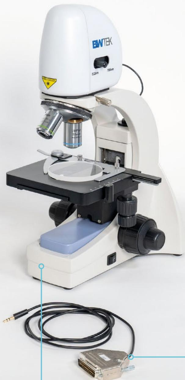
拉曼视频采样系统可以容纳各种尺寸的测量池，高度可达 30mm。
