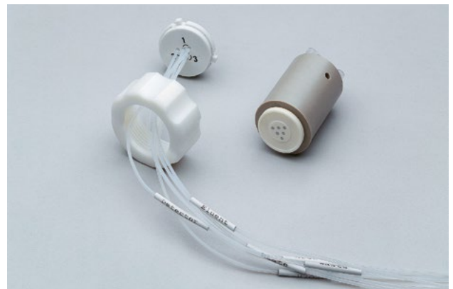
自动连续再生化学抑制器
