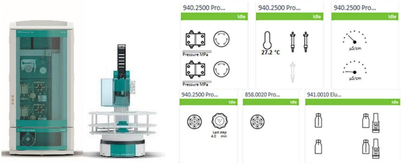
**Abbildung 1** (L) Setup für die Analyse von Kationen und suppressierten Anionen mit einem Metrohm 940 Zweikanal-IC (940 Professional IC Vario TWO) und Inline-Eluentproduktion mit einem 941 Eluent Production Module und (R) Konfiguration in OpenLab.
