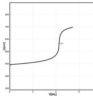
**Abbildung 2.** Titrationskurve für Perchlorsäure mit einem Äquivalenzpunkt.
