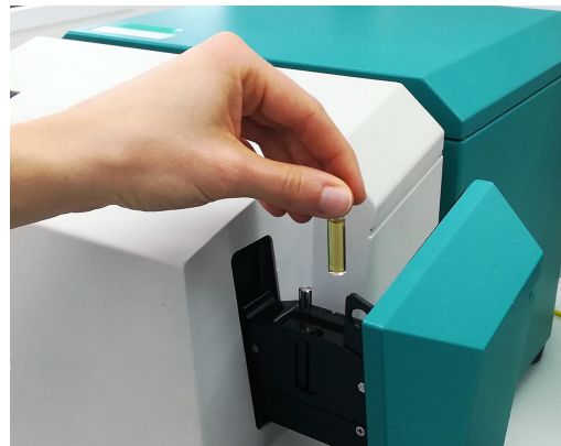
Abbildung 1. XDS RapidLiquid Analyzer mit einer Polyolprobe, die sich in einem 4 mm Einwegfläschchen befindet.
