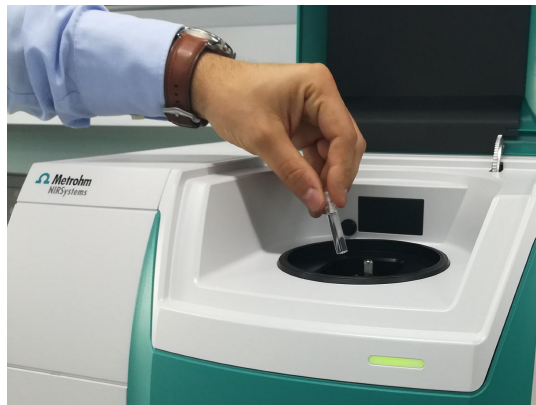
Abbildung 1. DS2500 Liquid Analyzer und eine in ein Einwegfläschchen gefüllte Probe.
