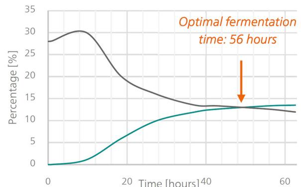
**Abbildung 1.** Trenddiagramm eines Ethanol-Fermentationsprozesses (grün: Ethanol, grau: Feststoffe [Enzyme]).
