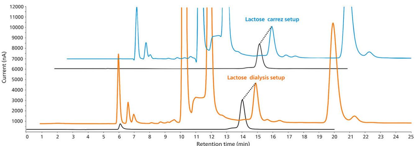
**Abbildung 3.** Lactosebestimmung in Babynahrung (NIST 2383a). Vergleich von zwei Probenvorbereitungsmethoden: Inline-Dialyse ( $c(\text{Lactose}) = 51,1$  mg/L, orange) und Carrez-Fällung ( $c(\text{Lactose}) = 49,6$  mg/L, blau). Die relative Standardabweichung der beiden Proben beträgt 2,1 %. Zum Vergleich ist ein 40 mg/L Lactose-Standard (schwarz) überlagert.
