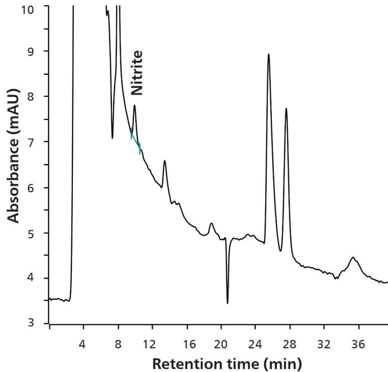
Abbildung 2. Chromatogramm für 288 µg/kg Nitrit in einer Hydroxypropylmethylcelluloseprobe.
