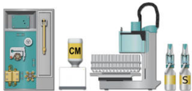
Abbildung 1. Aufbau für Trinkwasseruntersuchungen mit einem 930 Compact IC Flex mit automatischer KOH-Eluentenherstellung (948 Continuous IC Module, CEP), einem 858 Professional Sample Processor und der intelligenten Partial-Loop-Injektionstechnik (MiPT) von Metrohm.
