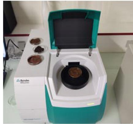
**Abbildung 1.** DS2500 Feststoffanalysator mit menschlichen Stuhlproben.
