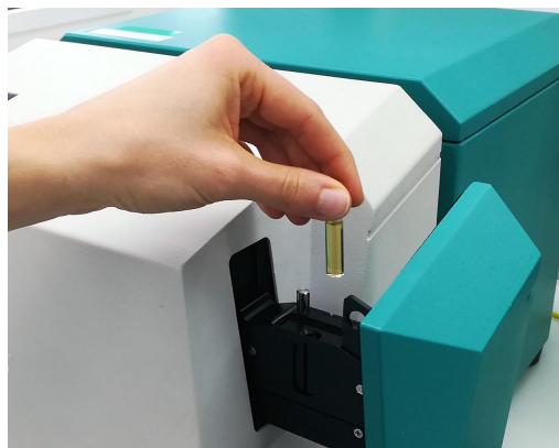
Abbildung 1. XDS RapidLiquid Analyzer mit einer Polyolprobe, die sich in einem 4 mm Einwegfläschchen befindet.
