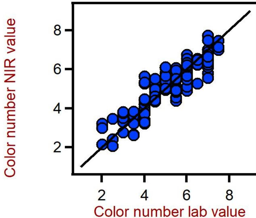
**Abbildung 6.** Korrelationsdiagramm für die Vorhersage der Farbzahl in Schmierstoffen unter Verwendung eines XDS RapidLiquid Analyzers. Der Laborwert der Hydroxylzahl wurde mit Hilfe der Photometrie ermittelt.
