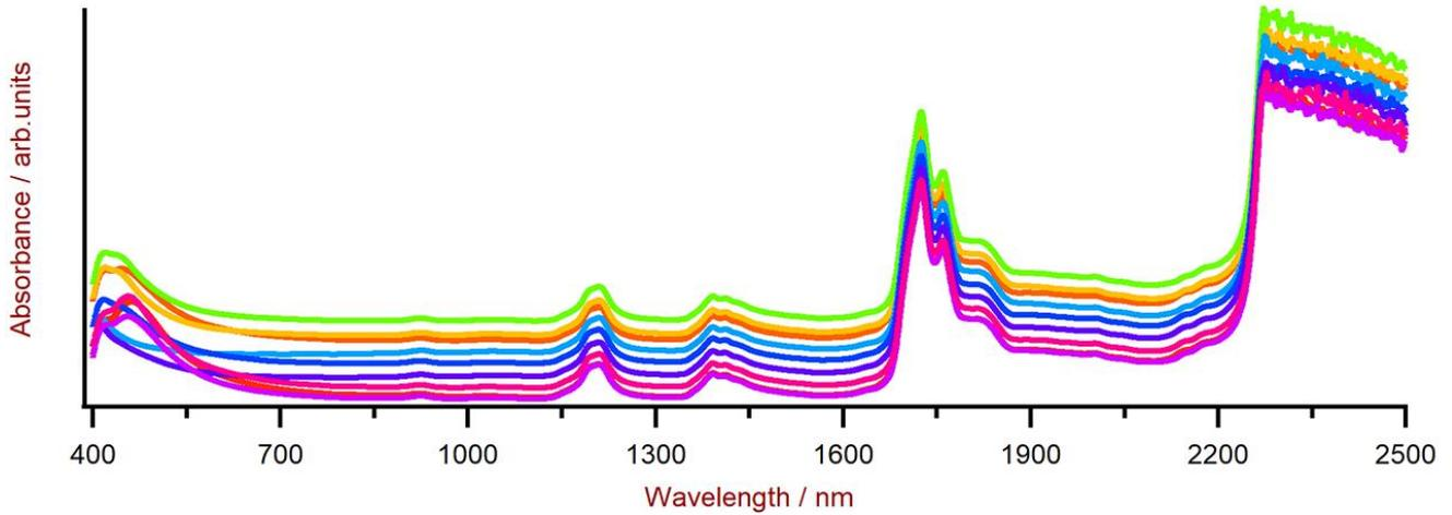
**Abbildung 2.** Auswahl von Schmieröl Vis-NIR-Spektren, die mit einem XDS RapidLiquid Analyzer und 8-mm-Einwegfläschchen aufgenommen wurden. Aus Darstellungsgründen wurde ein Spektren-Offset angewendet.
