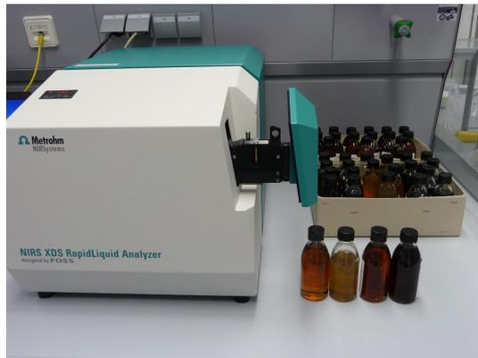
**Abbildung 1.** XDS RapidLiquid Analyzer und Schmierstoffproben.
