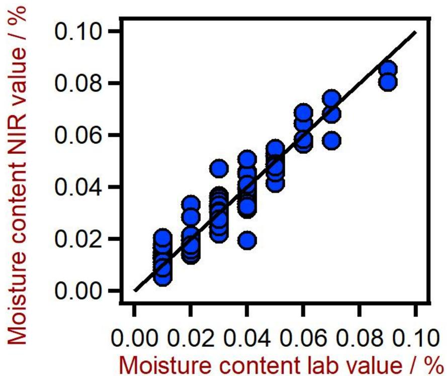
**Abbildung 5.** Korrelationsdiagramm für die Vorhersage des Feuchtigkeitsgehalts in Schmierstoffen mit einem XDS RapidLiquid Analyzer. Der Laborwert des Feuchtigkeitsgehalts wurde mithilfe der Karl-Fischer-Titration (KF) ermittelt.
