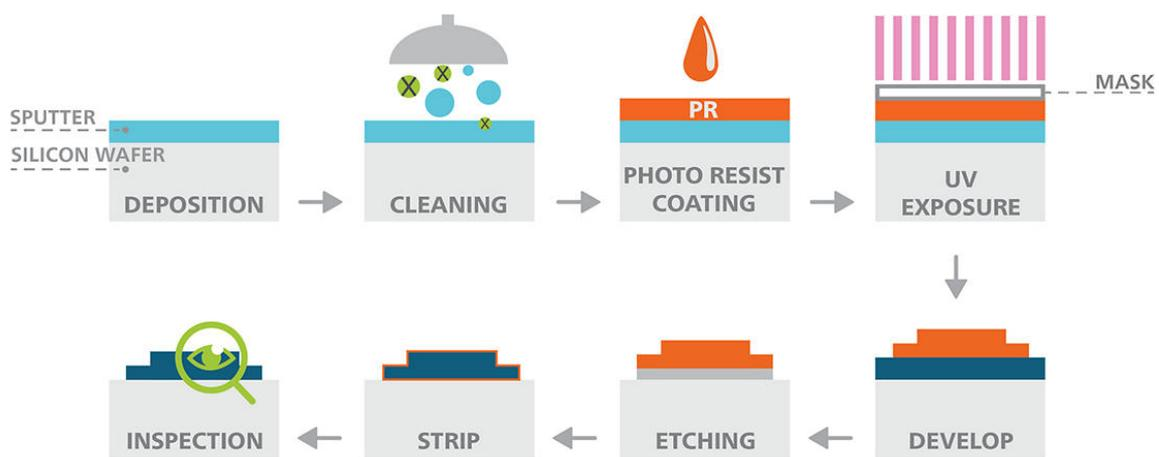
**Abbildung 1** Diagramm des Fotolithographieprozesses bei der Herstellung integrierter Schaltkreise.
