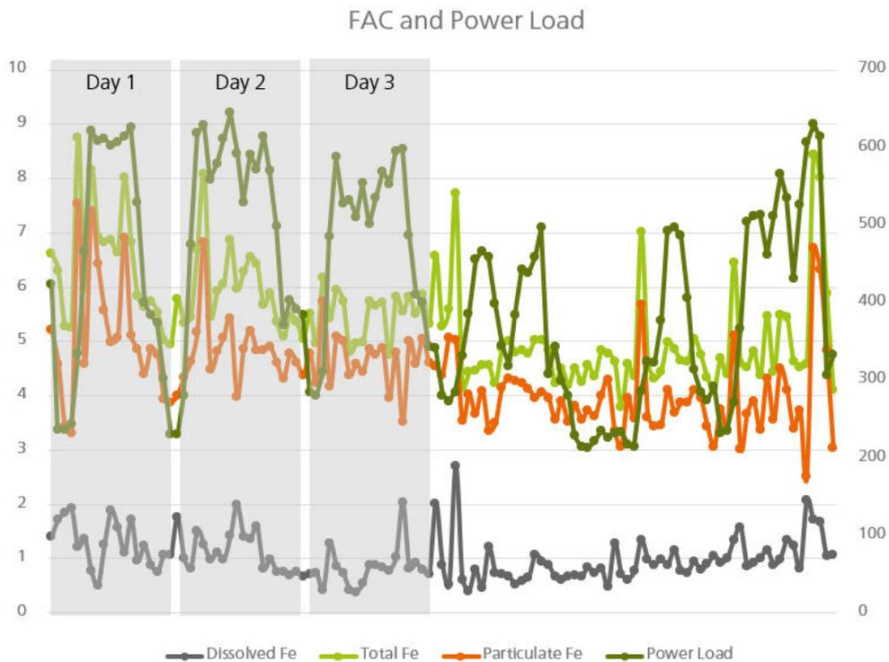
**Abbildung 3.** Daten aus einem Metrohm-Prozessanalysator in einem Kraftwerk, der zur Überwachung von gelöstem, gesamtem und partikulärem Eisen (in µg/L) verwendet wird, in Abhängigkeit von der Leistungslast (MW).
