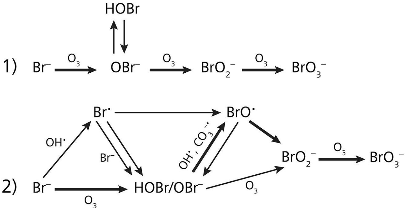
Abbildung 1. Mechanismen der Bromatbildung bei der Ozonierung.
