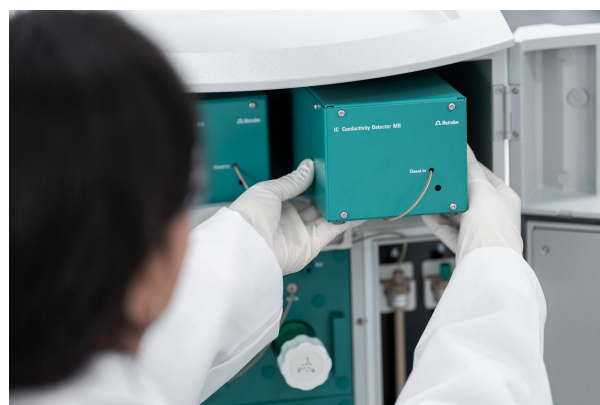
Abbildung 1. Der hier gezeigte IC-Leitfähigkeitsdetektor MB hat ein reduziertes Zellvolumen und ist inert gegenüber Methansulfonsäure.
