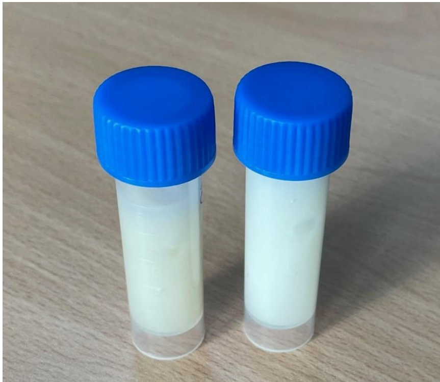
Abbildung 2. Kalt extrahiertes Fett aus gemahlene Würsten. Der Petrolether wurde bei 15 mbar und Raumtemperatur entfernt.
