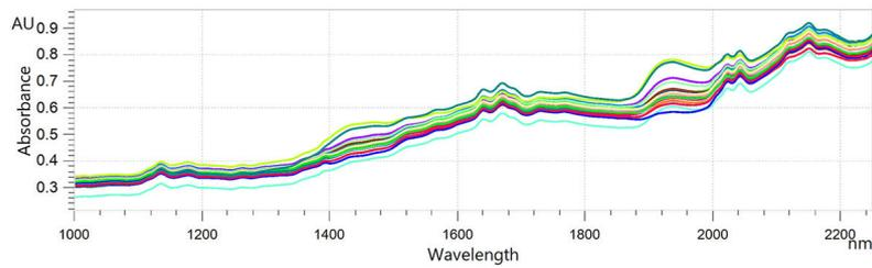
Abbildung 2. Gestapelte NIR-Spektren von Paracetamol-Tabletten, analysiert mit einem OMNIS NIR Analyzer Solid.
