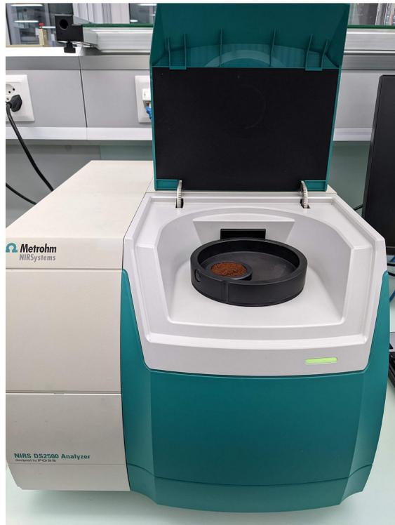
**Abbildung 1.** Ein Metrohm DS2500 Feststoffanalysator mit gemahlene Kaffeebohnen in einem NIRS-Miniprobebecher.
