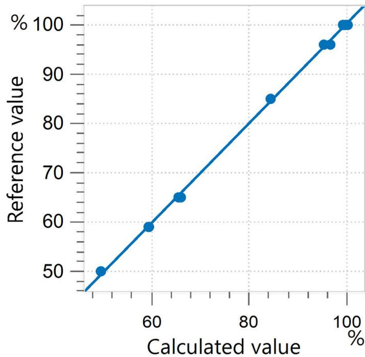
**Abbildung 3.** Korrelationsdiagramm und die jeweiligen Gütezahlen für die Vorhersage des Baumwollgehalts in Textilien unter Verwendung eines OMNIS NIR Analyzers Solid.
