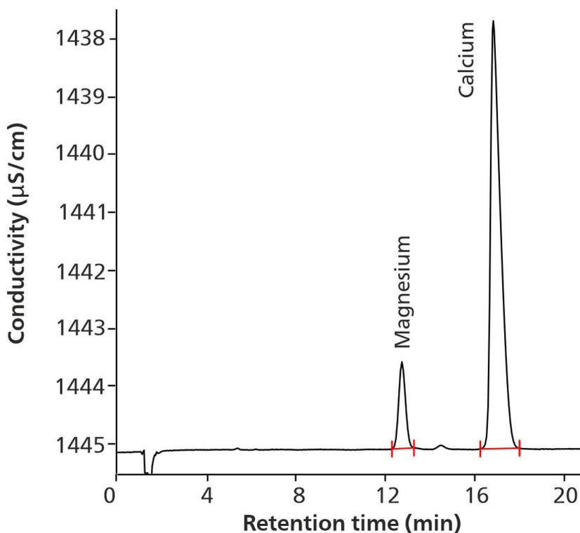
**Figure 2.** Señal de conductividad de magnesio y calcio en tabletas masticables Calcium 600 + D3 Plus Minerals (1,4 mg/L de magnesio, 15,0 mg/L de calcio) según la monografía "Calcium Carbonate and Magnesia Chewable Tablets" [2].
