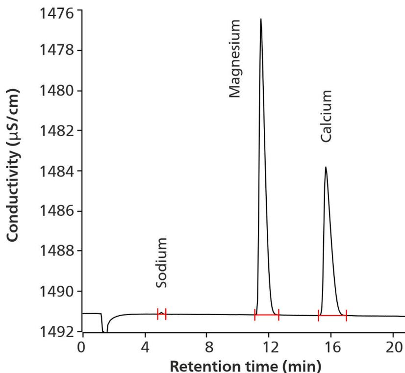
**Figure 1.** Señal de conductividad de sodio, magnesio y calcio en suplementos dietéticos quelantes de fosfato (16,0 mg/L de magnesio, 15,0 mg/L de calcio, sodio no cuantificado) según la monografía "Calcium and Magnesium Carbonates Tablets" [1].
