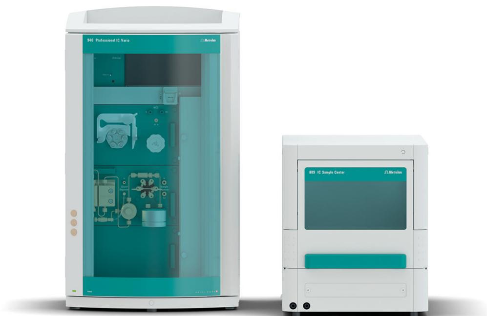
**Figure 1.** Configuración instrumental que incluye un 940 Professional IC Vario ONE/SeS/PP, un detector de conductividad IC (L) y el 889 IC Sample Center (R).
