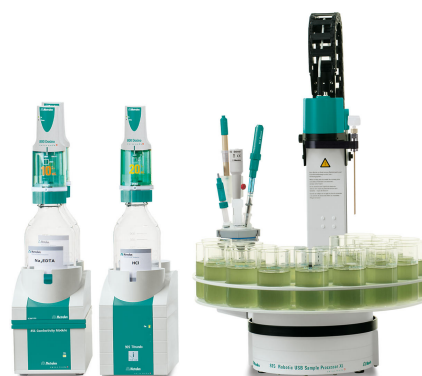
Figure 1. Sistema de ejemplo: 815 Robotic USB Sample Processor XL con recipiente de titulación externo, 905 Titrandos y 856 Conductivity Module equipado con iAquatrode plus, iAg-Titrode y celda de medición de conductividad de 5 anillos para el análisis de agua corriente.
