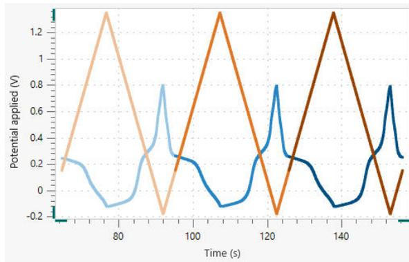
**Figure 7.** Gráfico de tiempo del potencial WE (naranja) y el potencial CE (azul). Los degradados de color claro (izquierda) son del primer escaneo, los degradados de color intermedios son del segundo escaneo y los degradados de color oscuro (derecha) provienen del tercer escaneo.
