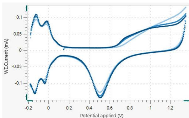
**Figure 6.** El voltamperograma cíclico del CV lineal en el electrodo de Pt en ácido sulfúrico. El primer escaneo está en azul claro, el segundo escaneo está en azul y el tercer escaneo está en azul oscuro.
