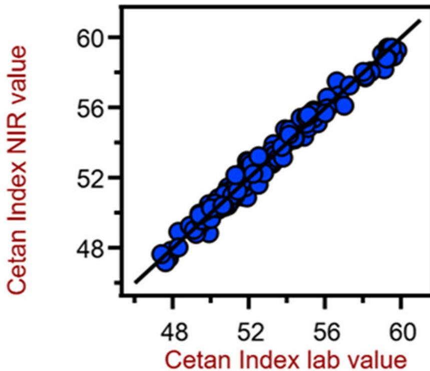
**Figure 3.** Diagrama de correlación para la predicción del índice de cetano usando un XDS RapidLiquid Analyzer. El valor de laboratorio del índice de cetano se calculó en función de la densidad y el rango de destilación.
