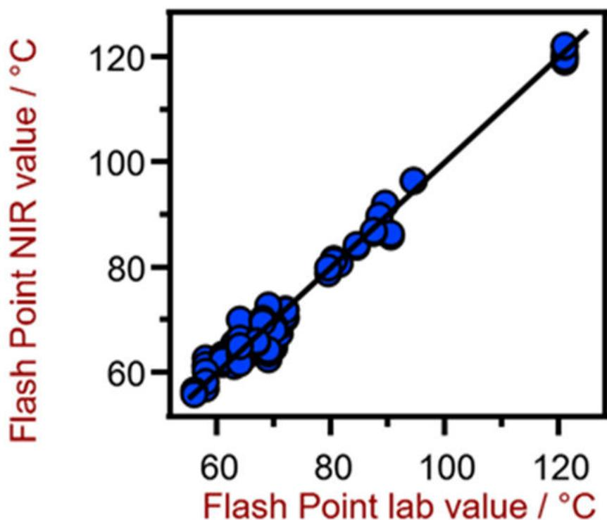
**Figure 4.** Diagrama de correlación para la predicción del punto de inflamación utilizando un XDS RapidLiquid Analyzer. El valor de laboratorio del punto de inflamación se evaluó usando un analizador de punto de inflamación dedicado.
