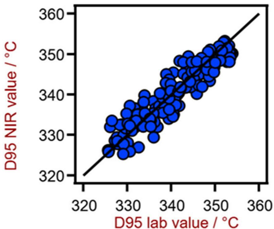
**Figure 6.** Diagrama de correlación para la predicción del valor D95 utilizando un XDS RapidLiquid Analyzer. El valor de laboratorio D95 se evaluó mediante destilación.
