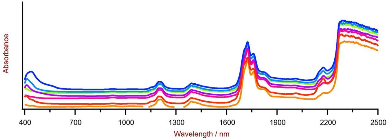
**Figure 2.** Selección de espectros diésel Vis-NIR obtenidos con un XDS RapidLiquid Analyzer y viales desechables de 8 mm. Por razones de visualización, se aplicó una compensación de espectros.
