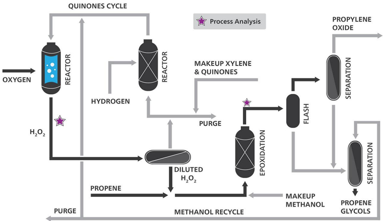
**Figure 1.** Diagrama de proceso esquemático que describe el método de peróxido de hidrógeno-óxido de propileno (HP-PO) para la producción de PO sin subproductos. Las estrellas señalan dónde se puede integrar el análisis de procesos en línea para operaciones más seguras y eficientes.
