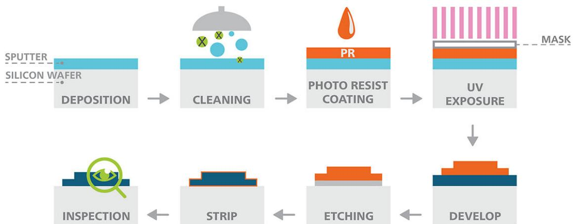
**Figure 1.** Diagrama del proceso de fotolitografía en la producción de circuitos integrados.
