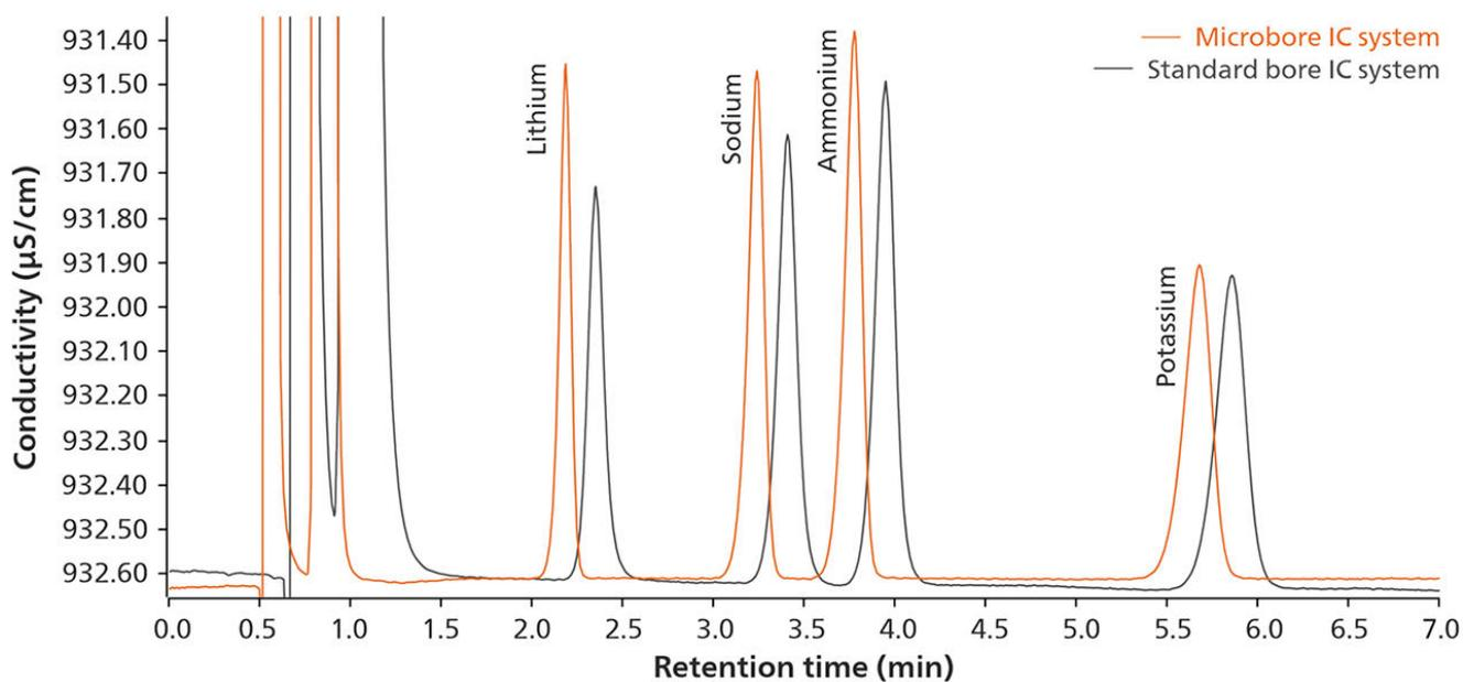
**Figure 2.** Comparación de los cromatogramas de iones de metales alcalinos (litio, sodio y potasio) y amonio en una columna de microbore Metrosep C 6 con microbore IC (MB, cromatograma naranja) y en un sistema IC de calibre estándar (SB, cromatograma gris). El sistema IC de microcalibre muestra formas de pico mejoradas, mayores alturas de pico y tiempos de retención más cortos.
