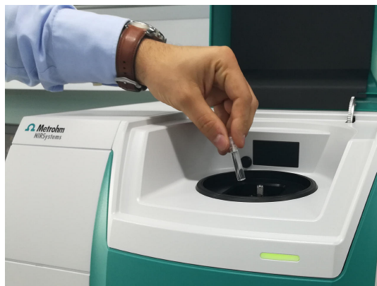
Figure 1. Analizador de líquidos DS2500 y una muestra de líquido de escape diésel en un vial desechable.
