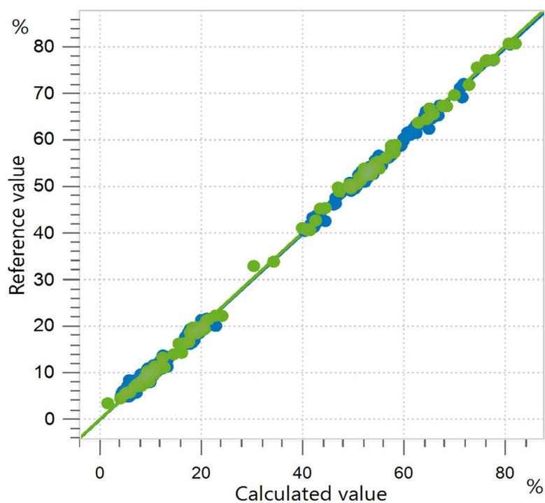
**Figure 9.** Diagrama de correlación y respectivas cifras de mérito para la predicción del contenido relativo de ácido graso C18:2 (ácido linoleico) en aceites comestibles utilizando un analizador líquido OMNIS NIR. Los valores de referencia se evaluaron mediante cromatografía de gases.
