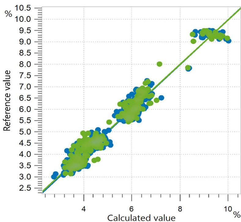
**Figure 6.** Diagrama de correlación y respectivas cifras de mérito para la predicción del contenido relativo de ácido graso C16:0 (ácido palmítico) en aceites comestibles utilizando un analizador líquido OMNIS NIR. Los valores de referencia se evaluaron mediante cromatografía de gases.
