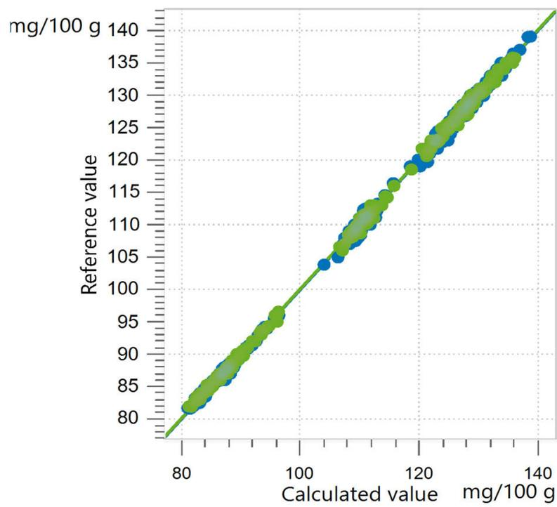
**Figure 3.** Diagrama de correlación y las respectivas cifras de mérito para la predicción del valor de yodo (también conocido como número de yodo) en aceites comestibles utilizando un analizador líquido OMNIS NIR. Los valores de referencia se evaluaron mediante cromatografía de gases.
