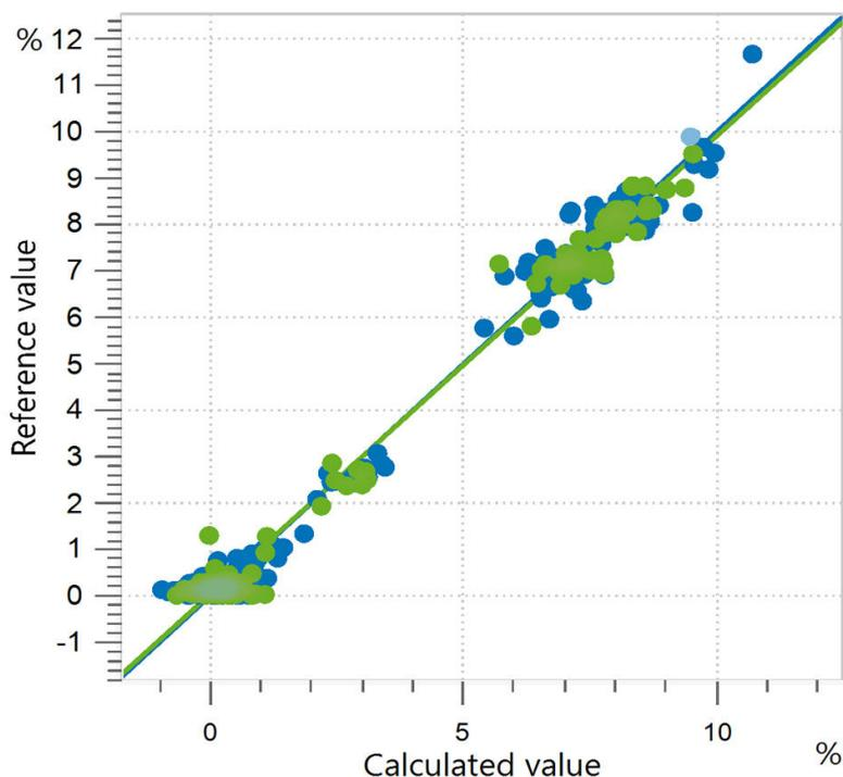
**Figure 10.** Diagrama de correlación y respectivas cifras de mérito para la predicción del contenido relativo de ácido graso C18:3 (ácido alfa-linolénico) en aceites comestibles utilizando un analizador líquido OMNIS NIR. Los valores de referencia se evaluaron mediante cromatografía de gases.
