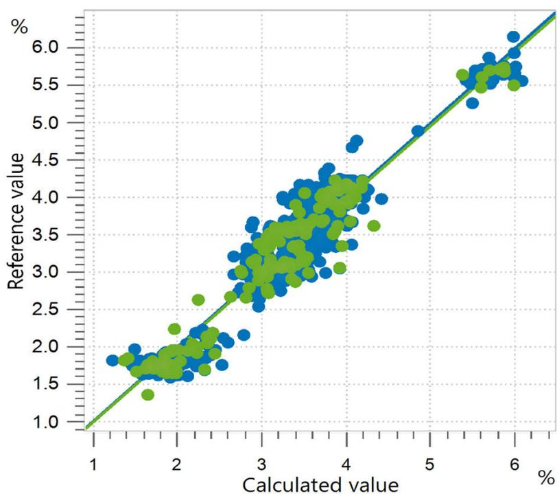
**Figure 7.** Diagrama de correlación y respectivas cifras de mérito para la predicción del contenido de ácido graso C18:0 (ácido esteárico) en aceites comestibles utilizando un analizador líquido OMNIS NIR. Los valores de referencia se evaluaron mediante cromatografía de gases.
