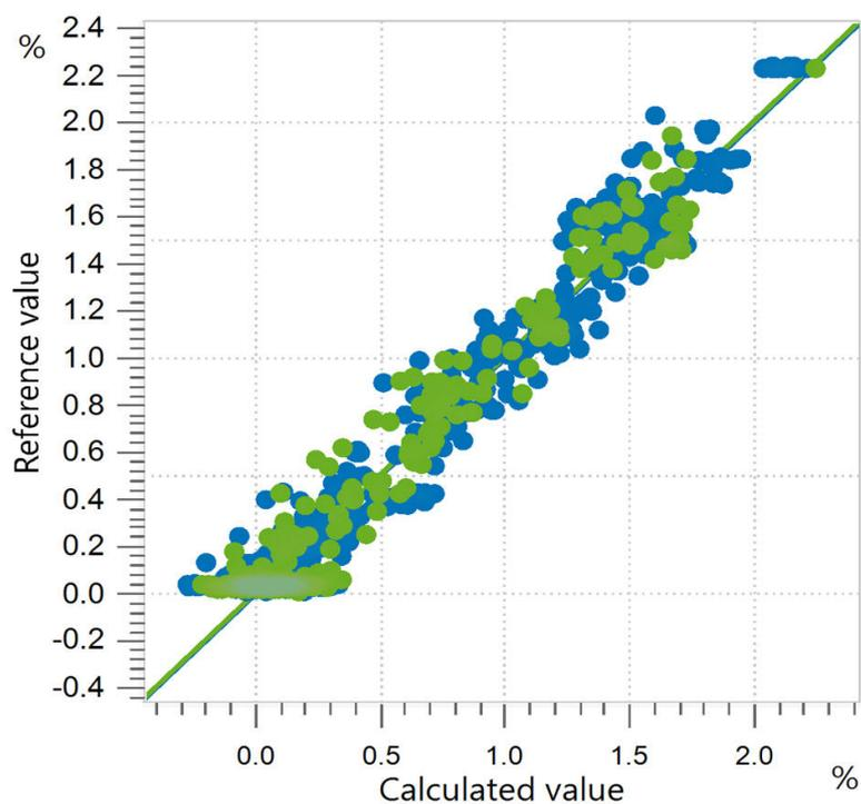
**Figure 4.** Diagrama de correlación y las respectivas cifras de mérito para la predicción de FFA en aceites comestibles utilizando un analizador líquido OMNIS NIR. Los valores de referencia se evaluaron utilizando un método de titulación.
