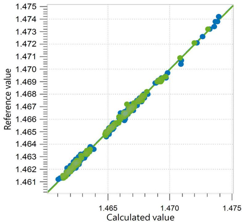
**Figure 5.** Diagrama de correlación y las respectivas figuras de mérito para la predicción del índice de refracción (IR) en aceites comestibles utilizando un analizador líquido OMNIS NIR. Los valores de referencia se evaluaron utilizando un refractómetro.
