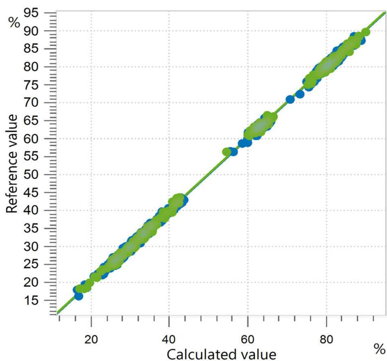
**Figure 8.** Diagrama de correlación y respectivas cifras de mérito para la predicción del contenido relativo de ácidos grasos C18:1 (ácido oleico) en aceites comestibles utilizando un analizador líquido OMNIS NIR. Los valores de referencia se evaluaron mediante cromatografía de gases.
