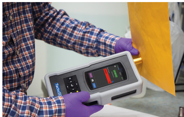
Figure 1. TacticID-1064 ST midiendo una muestra a través de un sobre de manila con adaptador ST
