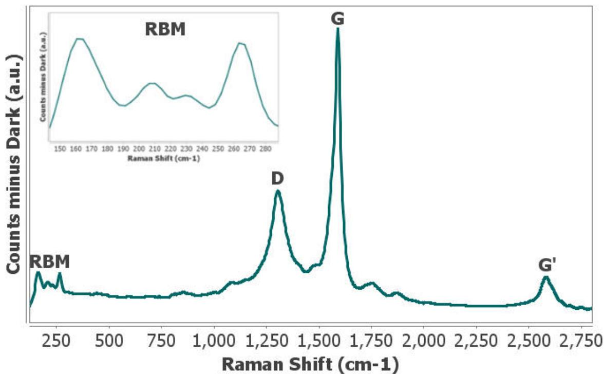
**Figure 1.** Espectro Raman característico de DRP-110SWCNT. Recuadro: bandas RBM.
