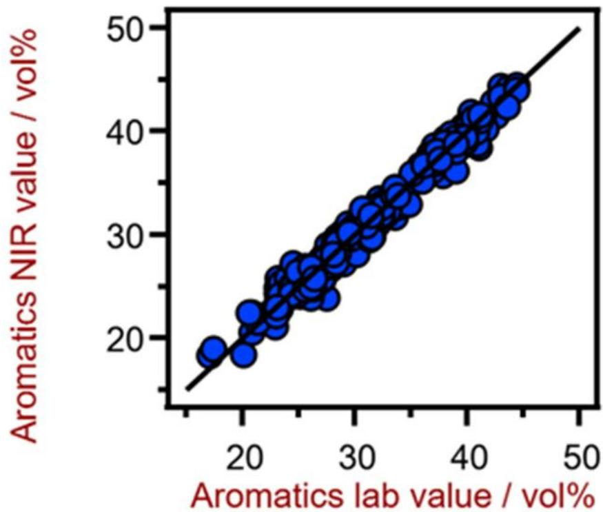
**Figure 5.** Diagrama de correlación para la predicción del contenido de aromáticos en gasolina usando un XDS RapidLiquid Analyzer. Los valores de laboratorio se determinaron con técnicas de cromatografía de gases/espectrometría de masas.
