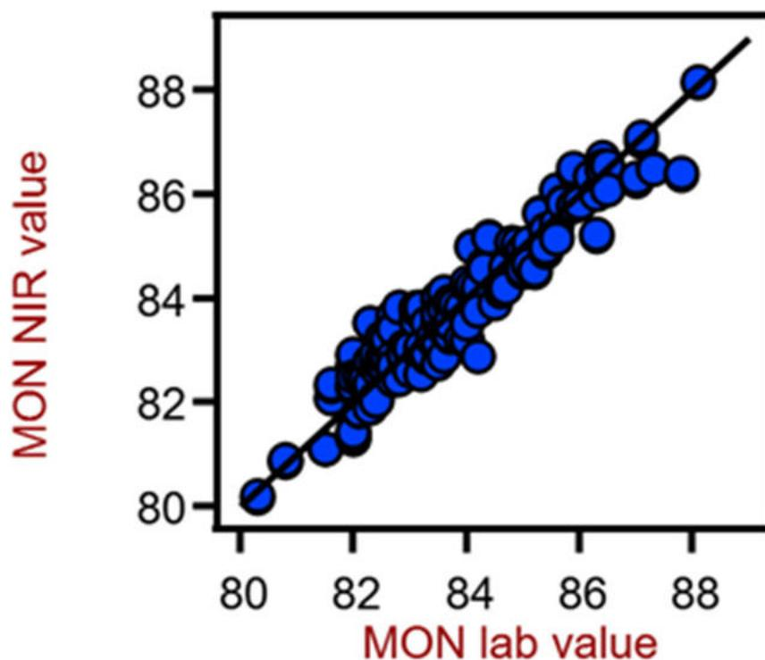
**Figure 4.** Diagrama de correlación para la predicción del valor MON en gasolina usando un XDS RapidLiquid Analyzer. Los valores de laboratorio de referencia se determinaron de acuerdo con las pruebas del motor CFR en condiciones controladas.
