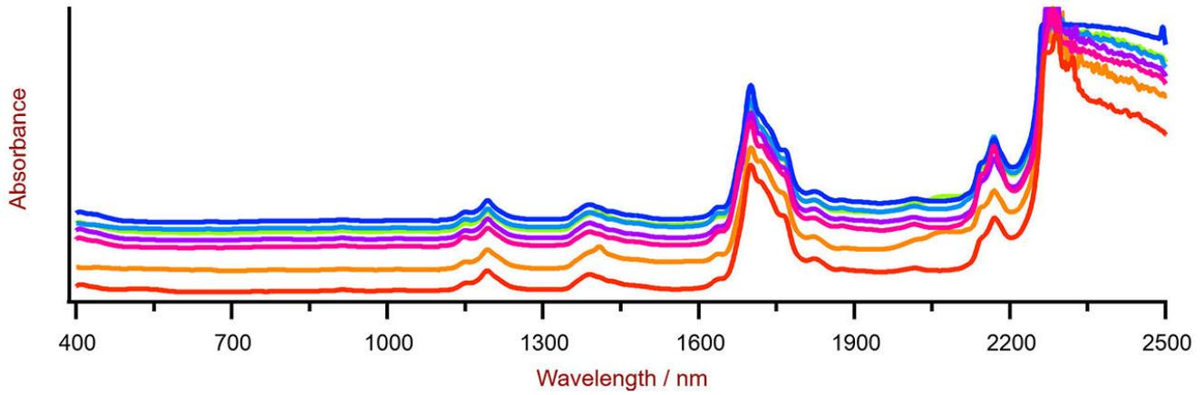
**Figure 2.** Esta selección de espectros Vis-NIR de gasolina se obtuvo utilizando un XDS RapidLiquid Analyzer y viales desechables de 8 mm. Por razones de visualización, se aplicó una compensación de espectros.
