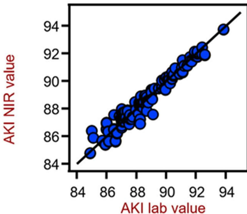
**Figure 7.** Diagrama de correlación para la predicción del valor AKI en gasolina usando un XDS RapidLiquid Analyzer. Los valores de laboratorio de referencia se determinaron de acuerdo con las pruebas del motor CFR en condiciones controladas.
