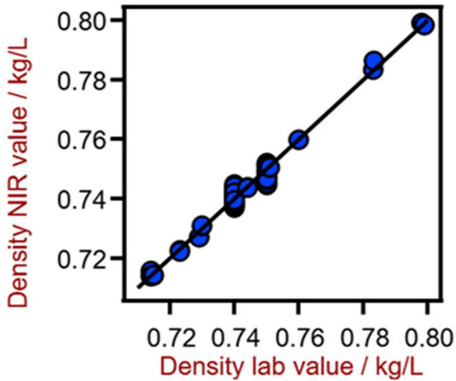
**Figure 6.** Diagrama de correlación para la predicción de la densidad de la gasolina utilizando un XDS RapidLiquid Analyzer. Los valores de laboratorio se determinaron utilizando un densímetro.
