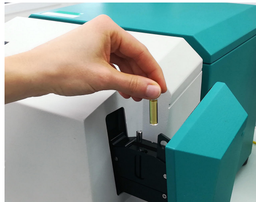
Figure 1. XDS RapidLiquid Analyzer y una muestra de isocianato presente en el vial desechable de 8 mm.
