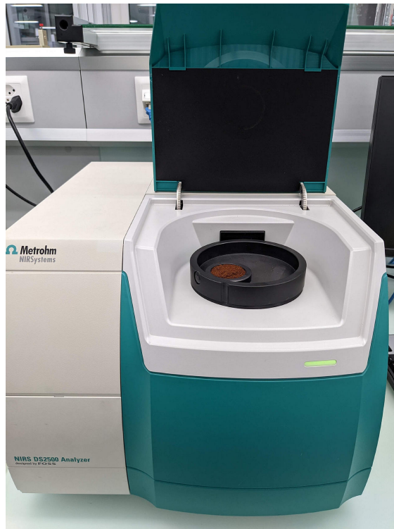
Figure 1. Un analizador de sólidos Metrohm DS2500 con granos de café molidos en una mini taza de muestra NIRS.
