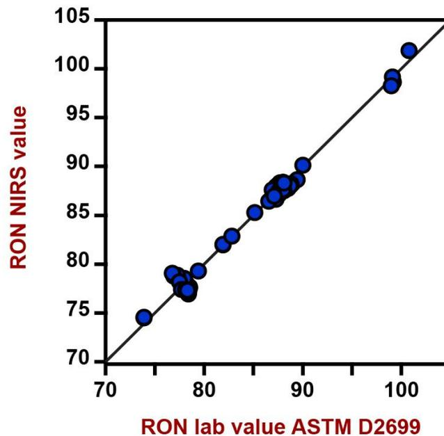
**Figure 3.** Diagrama de correlación y las respectivas cifras de mérito para la predicción del valor de RON utilizando un analizador de líquidos DS2500. El valor de laboratorio se evaluó de acuerdo con la norma ASTM D2699.
