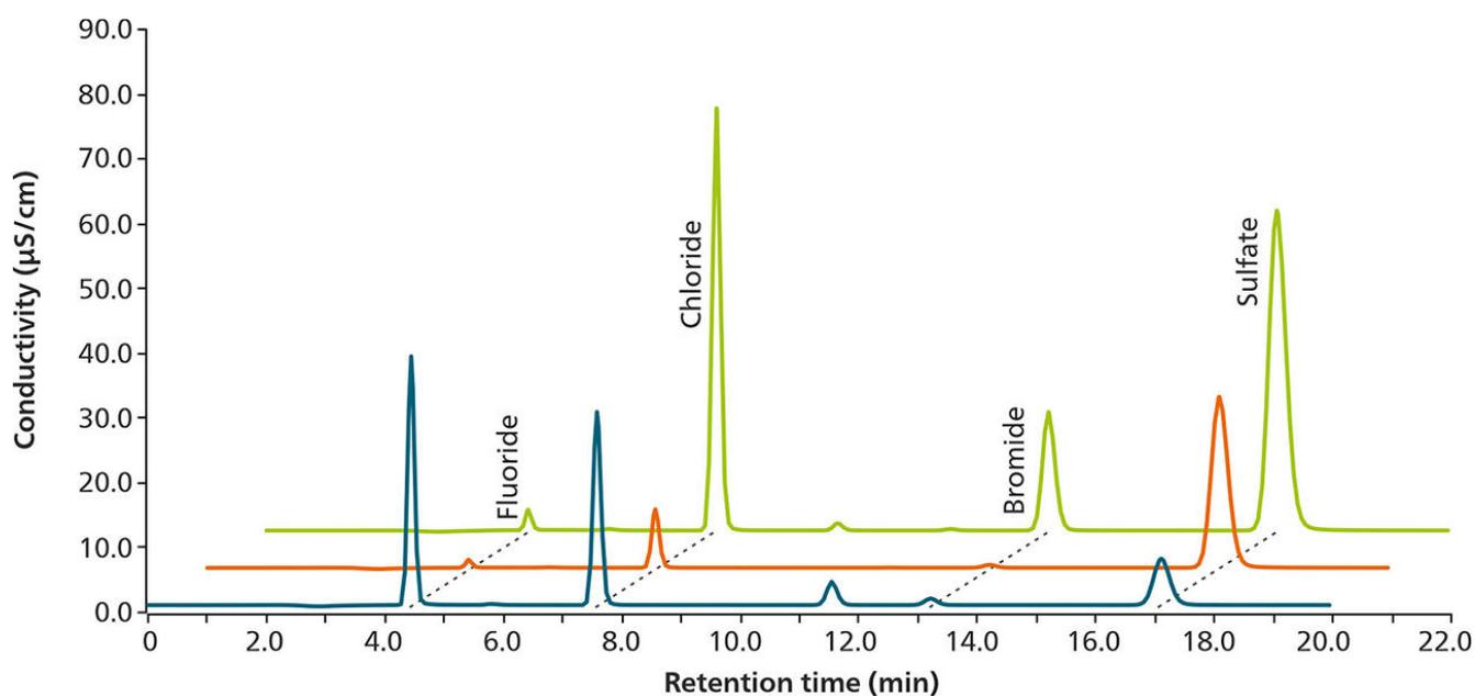
**Figure 2.** Superposition de chromatogrammes d'un échantillon de sol (bleu), d'un échantillon de boue (orange) et d'un échantillon de bois (vert). La séparation du fluorure, du chlorure, du bromure et du sulfate a été réalisée sur une colonne Metrosep A Supp 19 - 150/4.0 en utilisant l'éluant standard carbonate/bicarbonate. En utilisant un débit de 0,7 ml/min, tous les pics d'analyte ont été élués en 20 minutes et détectés à l'aide d'une conductivité séquentielle supprimée.
