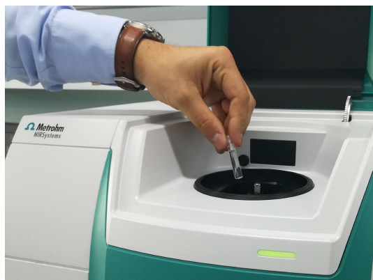
Figure 1. DS2500 Liquid Analyzer et un échantillon rempli dans un flacon jetable.
