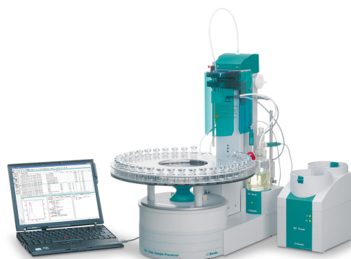
Figura 1. Sistema completamente automatizzato costituito da un 874 Oven Sample Processor con 851 Titrandi per il coulometrico Karl Fischer dopo la vaporizzazione dell'eventuale umidità presente nel campione.
