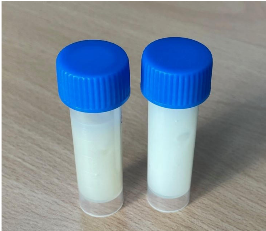
Figure 2. Grasso estratto a freddo da salumi macinati. L'etere di petrolio è stato rimosso a 15 mbar a temperatura ambiente.
