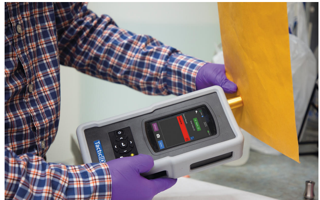
Figure 1. TacticID-1064 ST che misura un campione attraverso una busta manila con adattatore ST
